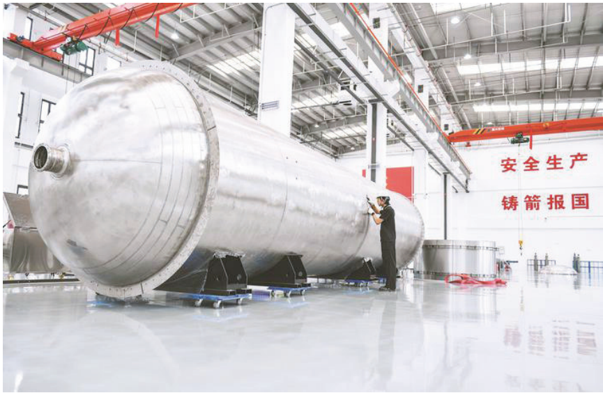
工程师正在对焊接成型的箱体进行检测。
