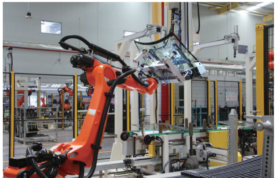
汽车前挡玻璃通过全自动化的流程在不同工序间流转制造。
