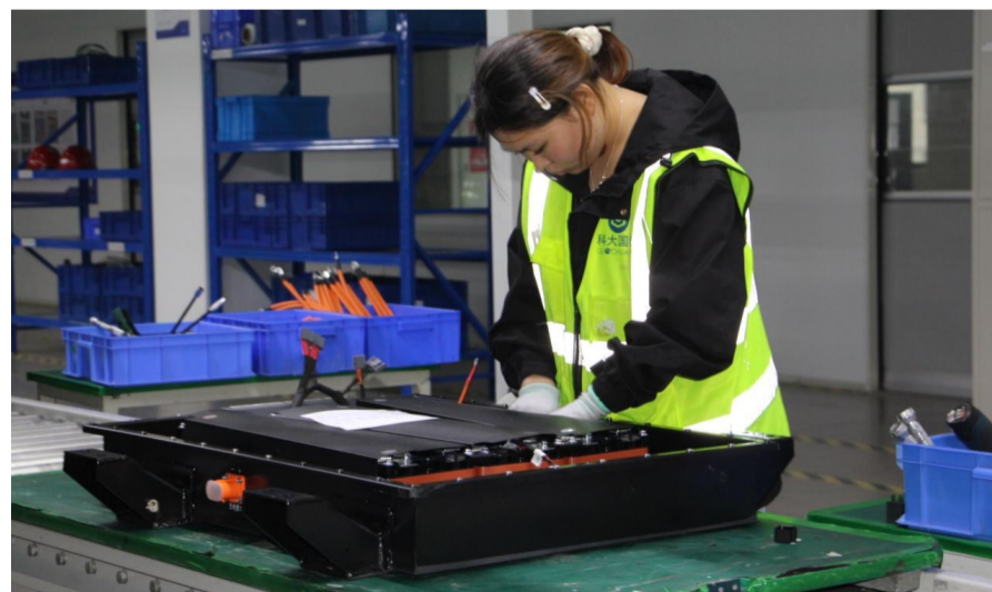
工人正在科大国创软件股份有限公司的新能源汽车电池包(PACK)组装生产线上作业。
