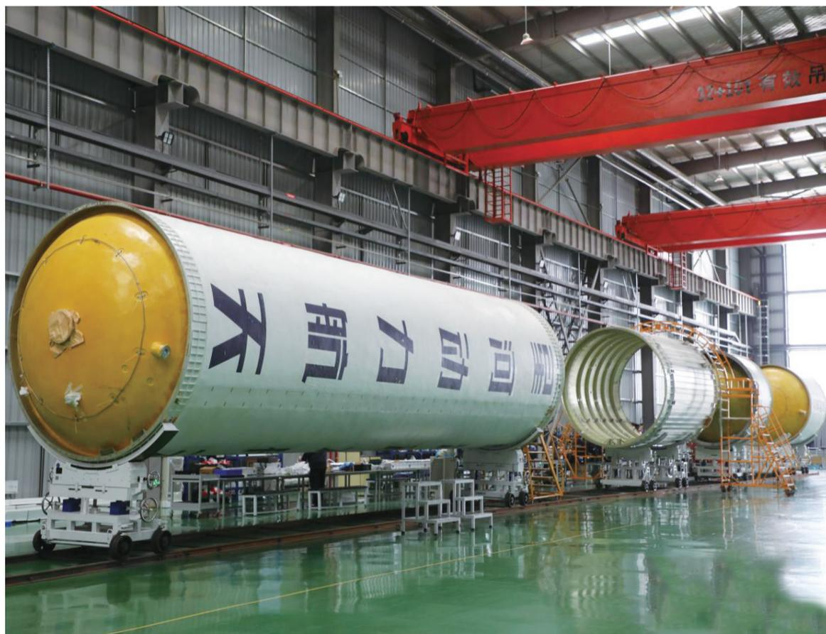
高端装备制造是池州市皖江江南新兴产业集中区的主导产业,其中,重点聚焦在商业航天领域。目前,池州已签约落户商业航天项目4个、总投资111.2亿元,如星河动力、飞渡航天、航天易龙、星移联信等,正在对接商业航天相关行业龙头企业超过10家,有望落户义兴光学等重点项目4个、总投资20.3亿元。图为池州皖江江南新兴产业集中区的星河动力总装车间。 罗广心 摄
