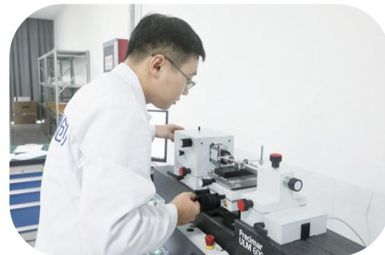
轴承研究所的职工在测量轴承尺寸。
