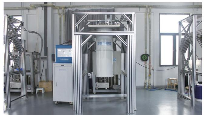
量子计算用极低温稀释制冷机。
