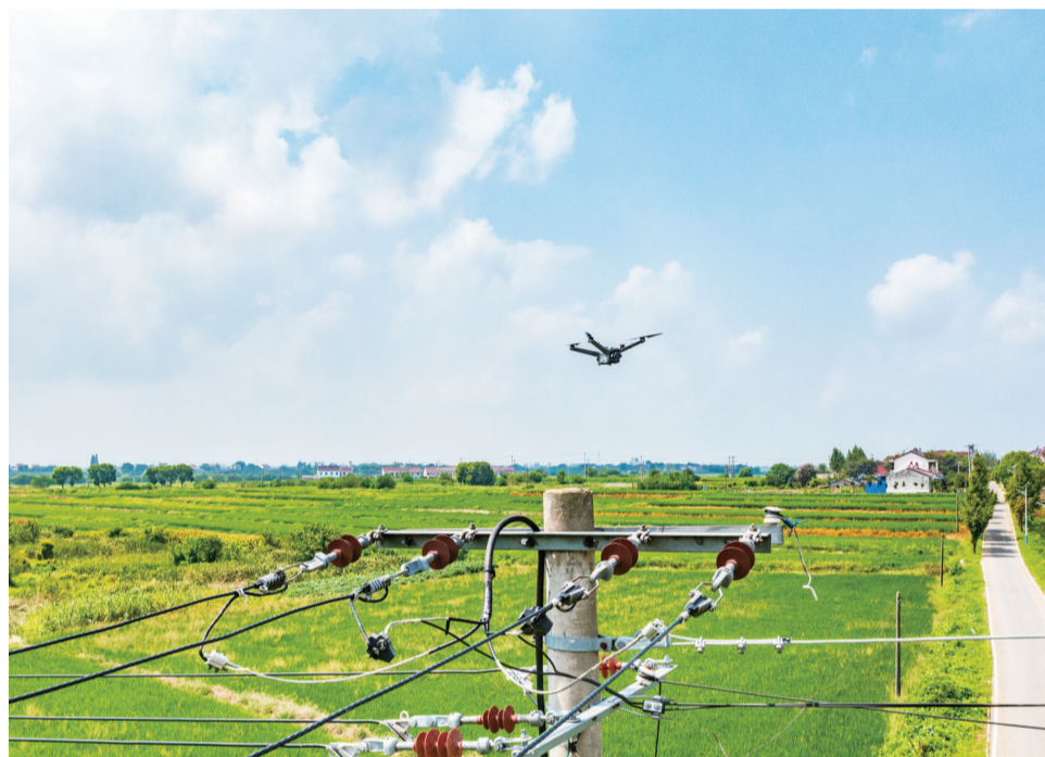
8月29日,国网合肥供电公司组织人员在庐江县郭河镇元井村调试合肥市首座在乡镇区域围绕中低压配网投入使用的无人机巢,结合行波测距等技术手段,针对10千伏供电线路及台区启动无人机自主智能巡检,为陕电入皖合州换流站电网高质量发展示范带再添科技力量。丁文康摄
