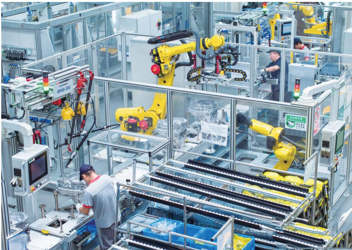
8月13日,芜湖市繁昌经济开发区安徽孚硕汽车动力系统有限公司,工人和工业机器人在SAT自动变速箱智能化生产流水线上作业。据了解,该公司生产制造的SAT自动变速箱是其自主研发并拥有完整的自主知识产权,摆脱了国外技术的限制和封锁。近年来,繁昌区持续深入优化营商环境,围绕汽车首位产业,加快发展新质生产力,重点发展汽车核心关键部件产业,促进当地经济社会高质量发展。
