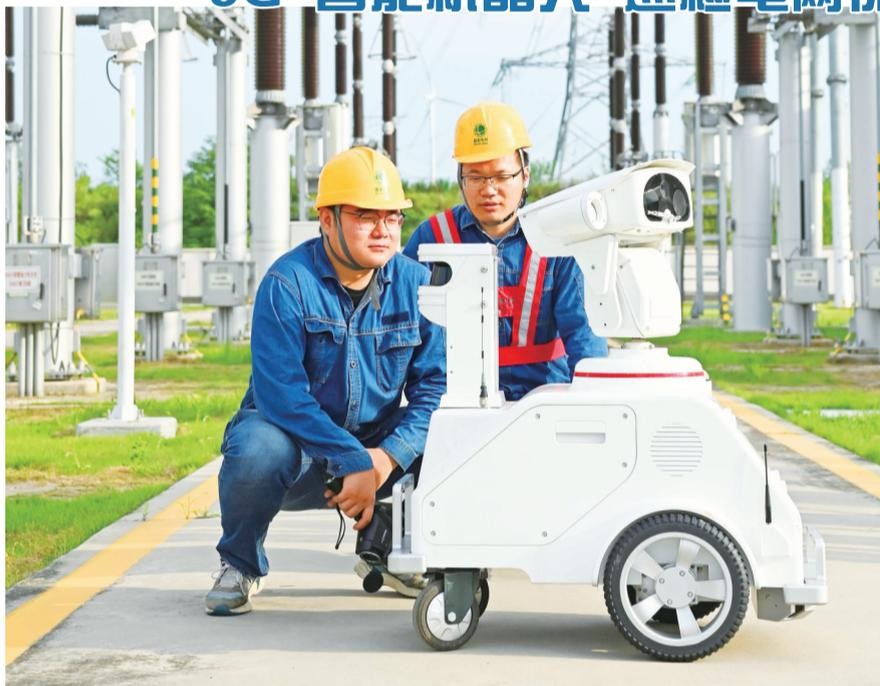
近日,在滁州市南谯区500千伏变电站,一台5G智能机器人和运维人员正在对站内供电设备进行特殊巡检,确保当地企业和居民夏季生产生活正常用电。为了预防新一轮高温天气和雷雨给电网带来一定危害,保障电网设备安全运行,滁州市供电公司在常规人工巡检的基础上,增设5G智能巡检机器人对全市供电设施进行全方位的巡检,启用“智能机器人+巡检人员复核”作业模式,发现隐患及时整改消除,确保滁州城乡人民群众生产生活用电可靠。
