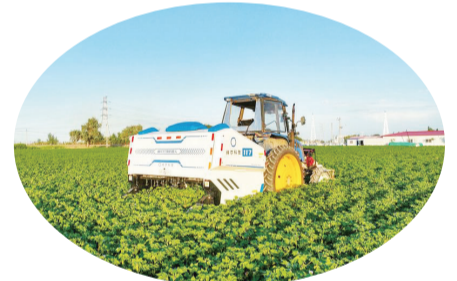
在新疆天业(集团)有限公司蘑菇湖现代农业示范基地,棉花打顶机器人正在作业。
