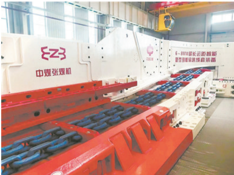
图为世界首台套8兆瓦超长运距智能刮板输送机。
