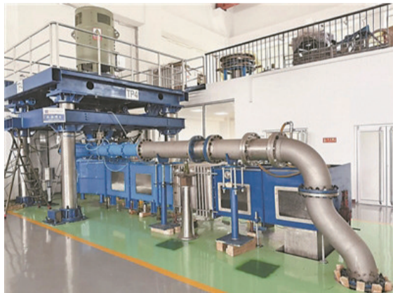
图为世界单机容量最大扎拉500兆瓦冲击式水轮机模型。
