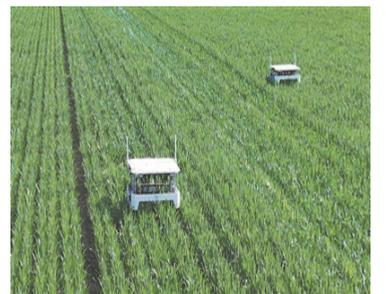
7月2日,纯电玉米去雄机器人在九圣禾种业股份有限公司制种玉米示范基地作业。 通讯员 叶飞摄
