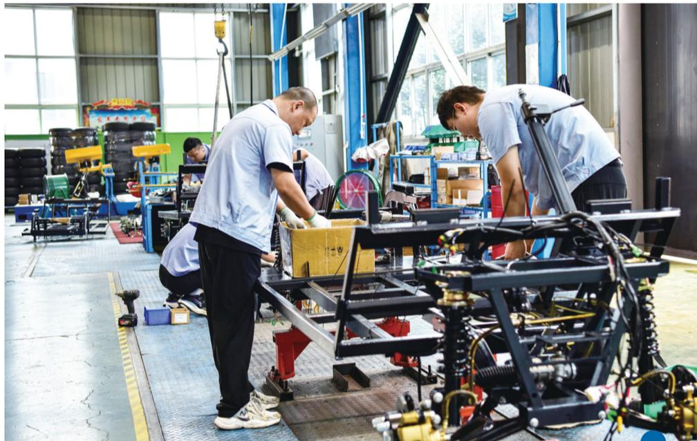
7月2日,安徽长丰(双凤)经开区的安徽华信电动科技股份有限公司生产车间,生产线上的工人们正有条不紊地组装电动高尔夫球车零部件,并进行相关性能测试。2023年以来,安徽华信电动科技股份有限公司立足自身研发生产智能化新能源环卫整车装备优势,研发制造电动高尔夫球车出口欧美国家,大力拓展海外市场,不断提升车辆在行业领域的竞争力。
