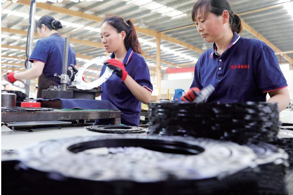
6月3日,在淮北市濉溪经济开发区一家制动系统生产制造企业,工人在生产车间生产电动车制动盘产品。淮北市濉溪经济开发区依托铝基新材料基地产业优势,大力发展汽摩配套产业,积极引进汽摩零部件生产企业入驻,通过专注细分领域,走专精特新之路,用小部件敲开大市场。
