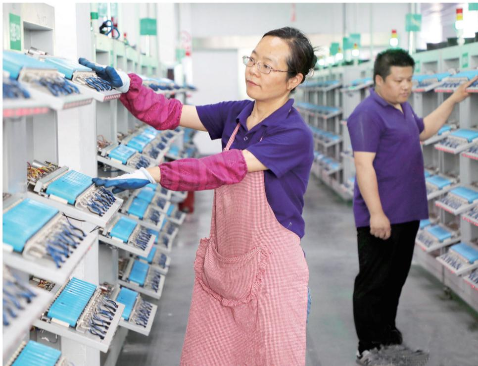
5月10日,在位于六安市舒城经济开发区杭埠园区的安徽绿沃循环能源科技有限公司分容车间,工人在对已包膜的电池进行充电。据了解,该公司是一家专业从事新能源汽车废旧动力电池综合利用的高新技术企业,是安徽省唯一一家具备完整产业链“三资质”(整车拆解、梯次利用、再生利用)企业,公司致力于废旧锂电池、报废新能源汽车等“城市矿产”报废资源的循环利用与循环再造产品的研究与产业化,打造新能源汽车动力电池全生命周期价值链及生态链体系。田凯平 摄
