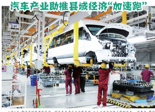
5月9日,蒙城县经济开发区内一家汽车生产企业总装车间,工人正在流水线上装配汽车。近年来,蒙城县把汽车及装备制造产业作为首位产业,依托江淮汽车、国家级汽车中心批发市场,全县汽车产业已经发展成为以汽车生产、销售、改装、维修、零配件供应、二手车交易、物流、驾驶员培训等为主的产业集群,2020年被省政府评为省级县域汽车零部件特色产业集群(基地)。 胡卫国摄
