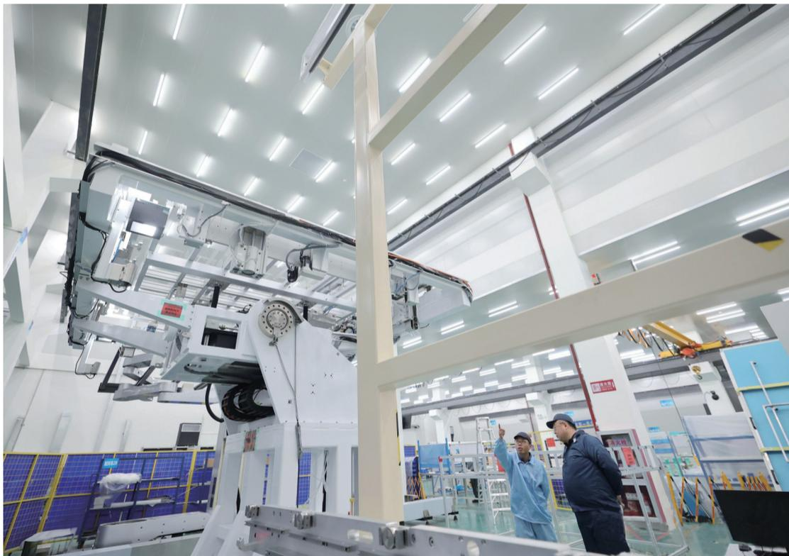
4月17日,在位于合肥市新站高新区的合肥欣奕华智能机器股份有限公司智能装备车间里,技术工人正在调试G8.6代液晶基板垂直自动搬送系统。近年来,合肥市新站高新区围绕制造业转型升级发展需要,以智能制造为主攻方向,大力推进工业互联网、大数据、人工智能等和制造业深度融合,推动制造企业加快智能化改造和数字化转型升级步伐,提升企业发展质量、效益和核心竞争力,让新质生产力助推战新产业高质量发展。张敏 摄
