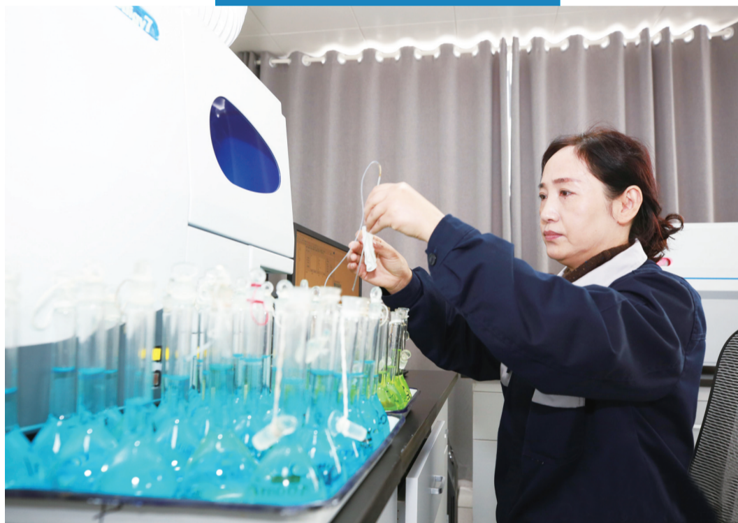
3月13日,在安徽省铜产业链绿色发展产业创新研究院ICP室(电感耦合等离子体发射光谱仪室),化验员在测定铜精矿、粗铜中杂质元素含量。潘伟 摄
