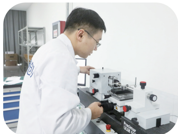
轴承研究所的职工正在测量轴承尺寸。
