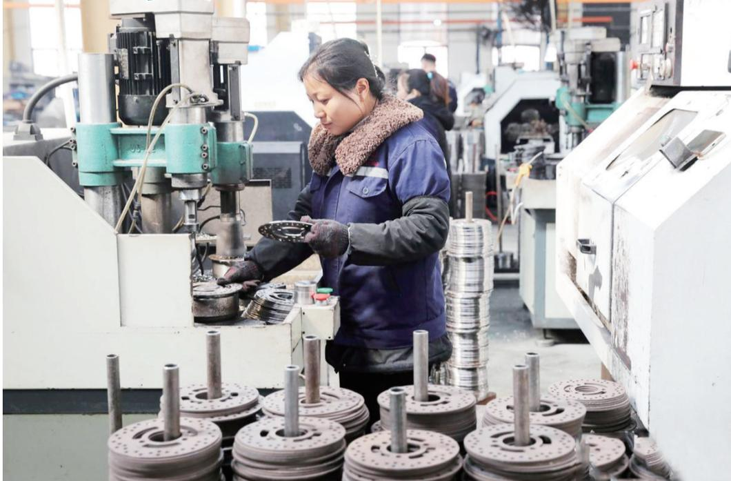
2月28日,在淮北市濉溪经济开发区一家机车制动部件生产企业,工人在车间生产机车刹车盘。近年来,濉溪经济开发区大力发展汽摩配产业,积极引进汽车零部件生产企业入驻,通过专注细分领域,走专精特新之路,用小部件敲开大市场。
